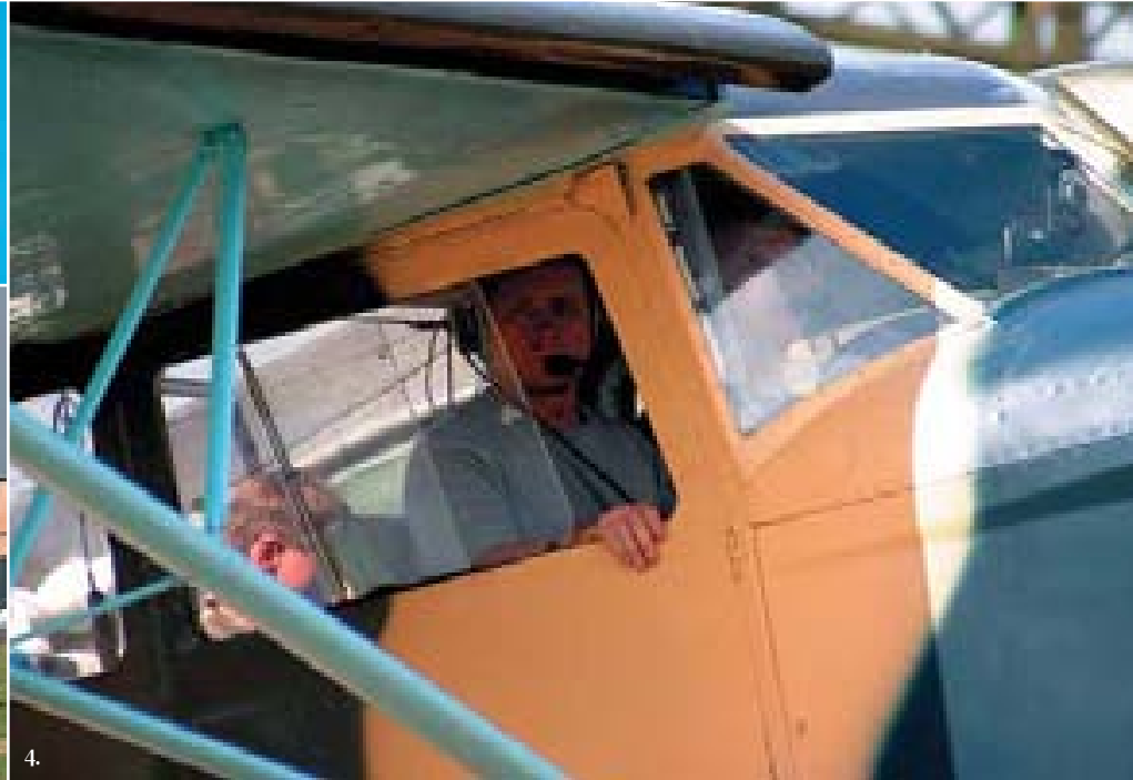
4. Сходство с какой-то наземной машиной усиливают двери автомобильного типа со сдвижными форточками
